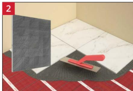
• Após a colocação do primeiro ladrilho remover e garantir que o ladrilho está recebendo uma cobertura total de adesivo da aplicação.
