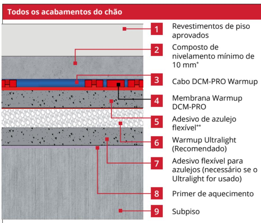
\* Este método pode ser utilizado para criar uma superfície de pavimento adequada para a maioria dos acabamentos de pavimentos e ao formar um declive de drenagem dentro de um wetroom. O composto de nivelamento, quando utilizado, deve ser aplicado como uma única camada. As camadas adicionais de composto de nivelamento devem não ser acrescentado. Verificar com o fabricante de pavimentos a adequação ao aquecimento do pavimento.
