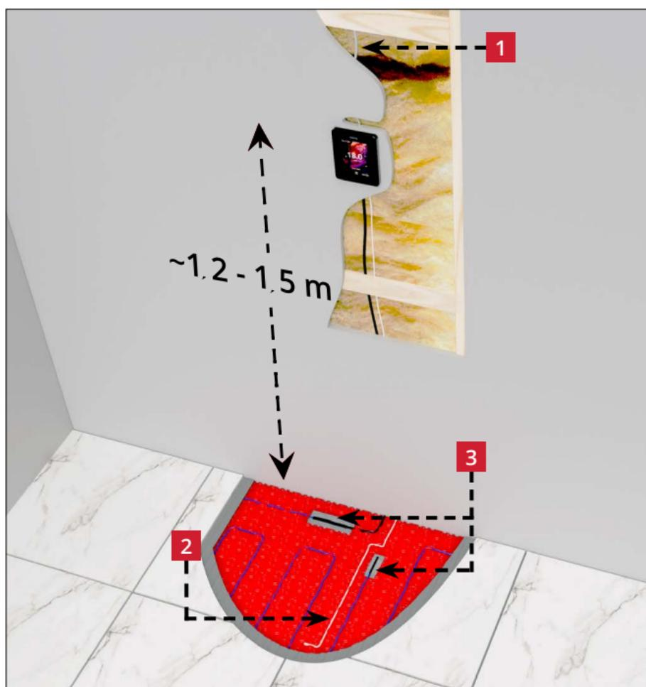
**1** A alimentação do termostato DEVE estar sempre protegida por um Disjuntor ou RCBO de 30mA. RCDs ou RCBOs com retardo de tempo não devem ser usados. Não mais do que 7,5 kW de aquecimento devem ser conectados a cada disjuntor ou RCBO de 30 miliampères. Para cargas maiores, use vários disjuntor ou RCBOs.
