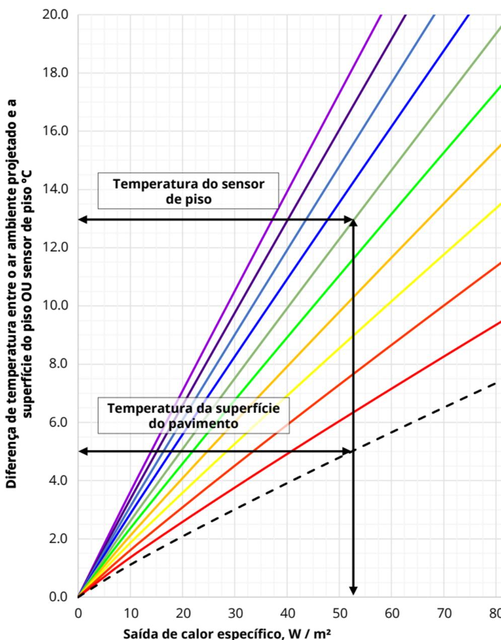
Usando o gráfico acima, é possível obter a saída de calor específico de um sistema de piso radiante elétrico com base na diferença de temperatura entre a temperatura do ar ambiente de projeto e a temperatura da superfície do piso ou do sensor do piso por acabamento do piso.
