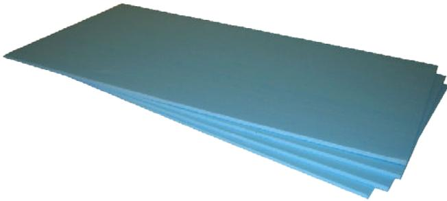
El panel aislante sin revestimiento de Warmup® es una lamina impermeable fabricada de poliestireno extruido. Cuando aplicada en conjunto con sistemas de malla o hilo radiante se necesita colocar una capa de 1 a 1,5 cm de cemento-cola flexible entre el panel y el sistema de calefacción.
